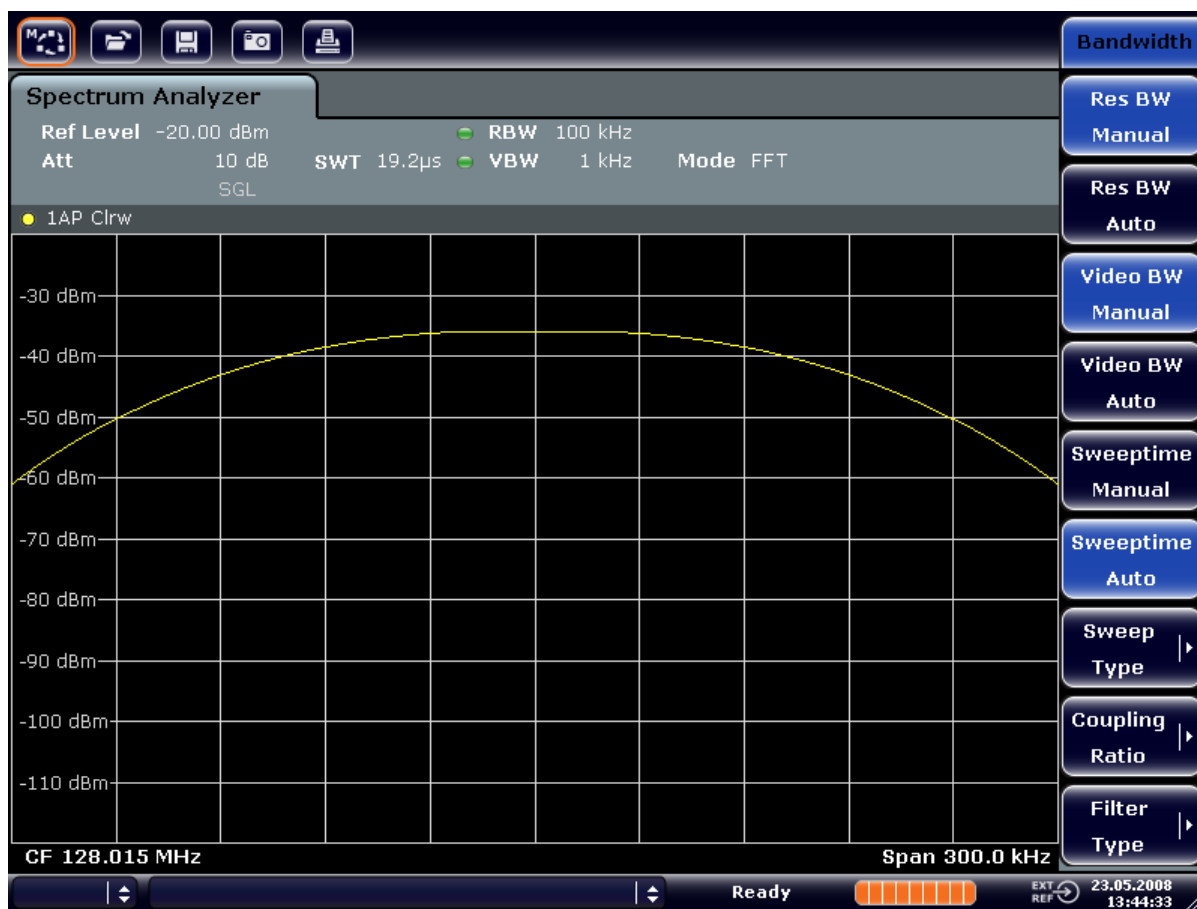
Fig. 6-5 : Mesure de deux signaux RF sinusoïdaux de même niveau avec une largeur de bande de résolution supérieure à leur écart de fréquence.
